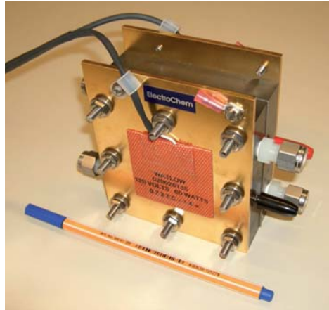
Abb. 7-11: Assemblierte Einzel-Brennstoffzelle der Firma Electrochem Inc. Typ EFC25-02SP.
